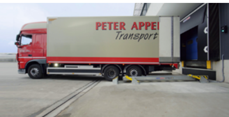
Grote wioldiameter, dubbele achteras en onderrijbeveiliging aan de zijkant.
